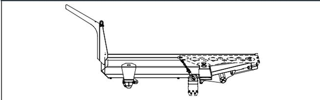
Optional: Kippmulde mit mechanischer Heckklappe
